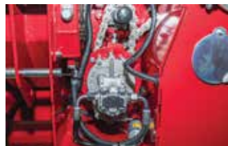
La pompe est entraînée par un multiplicateur à engrenages. Un filtre à pression est placé après la pompe pour assurer additionally la propreté de l'huile du système.
